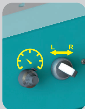
Regolazione velocità di avanzamento e direzione del nastro
